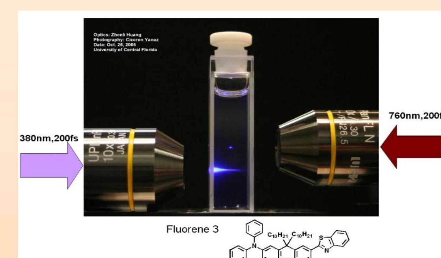
In procesul interactiei bifotonice, in centrul spotului laser focalizat unde intensitatea laser depaseste pragul efectului neliniar, materialul absoarbe doi fotoni la 800 nm, cu energie echivalenta cu a unui singur foton la 400 nm, initializand astfel procesul de fotopolimerizare a materialului.
