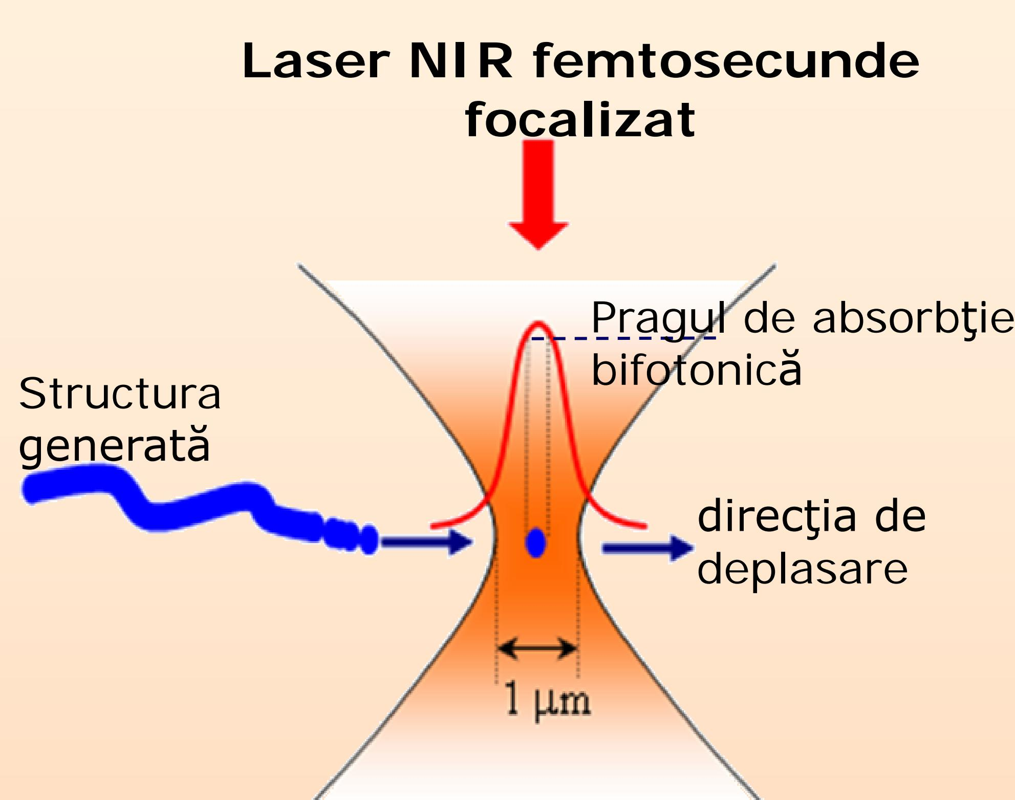
In materialele de tip fotorezist folosite in fotolitografia clasica, transparente la radiatia NIR (infraroșu apropiat), putem focaliza pulsurile laser cu emisie la 800 nm in volumul materialului fara ca radiatia optica sa fie absorbita la suprafata.
