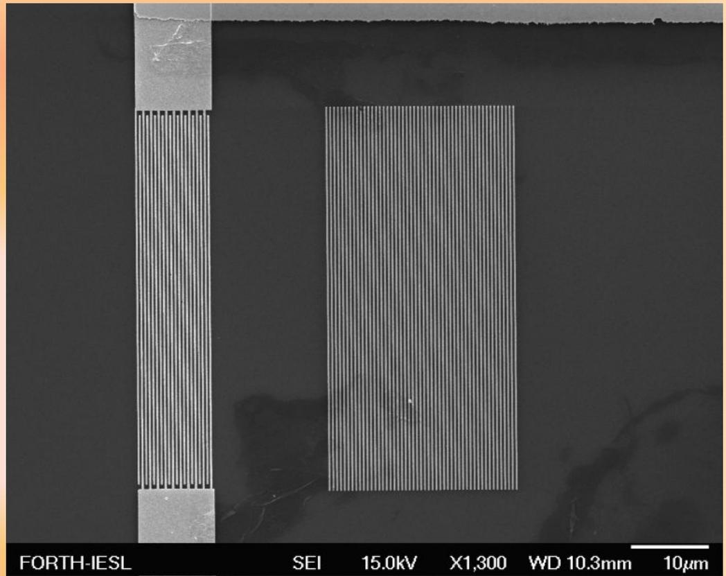
**SAW structure ( $W=250\text{nm}$ )**
