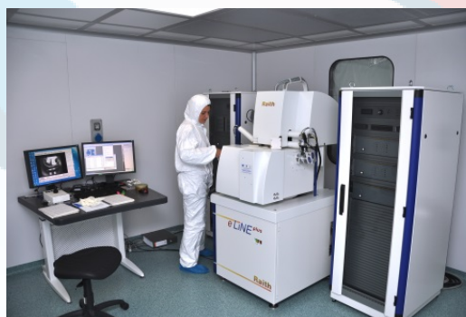
Instalație de nanolitografiere cu fascicul de electroni de rezoluție ultraînaltă (cu Gas Injection System, 2 nanomanipulatoare)
