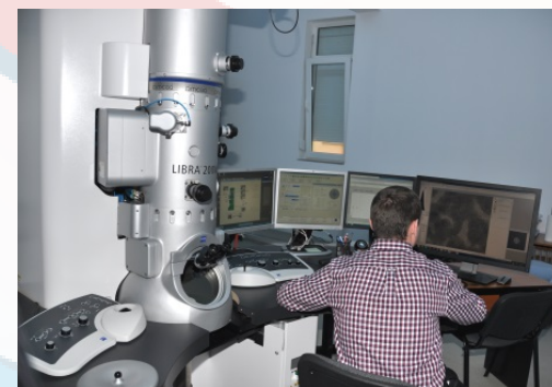
Microscop electronic de transmisie de rezoluție ultraînaltă (cu monocromator, filtru de energie, corector de imagine, EDX, lentilă Lorentz)
