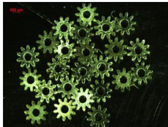
Roti dintate cu profil cicloidal extrase de pe substrat
