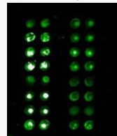
Imaginea scanată cu anticorpii imobilizați fluorescent pe suprafața de siliciu poros
