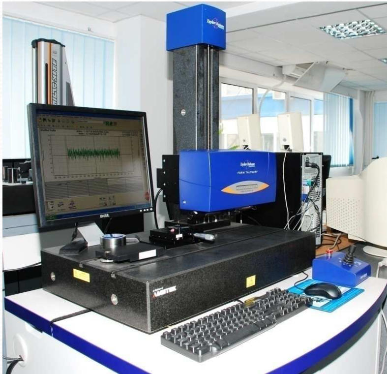
Echipament mecatronic Form Talysurf 120- Taylor Hobson Achiziționat prin Programul CAPACITĂȚI 2007-2009
