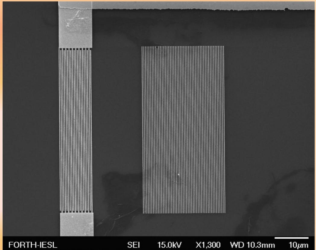
**SAW structure ( $W=250\text{nm}$ )**
